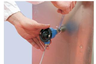
Fissare il pozzetto termobarico al processo
